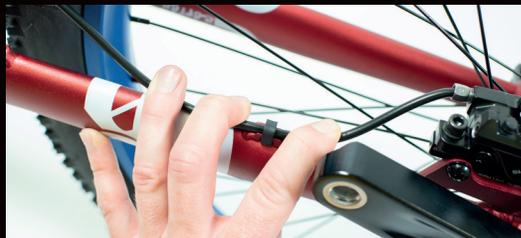
19) Die Bremsleitung um die Stütze wickeln oder kürzen (Video dazu in unserem YouTube-Kanal), Entlüften dann nicht vergessen. Die Bremsleitung am Rahmen mit den zwei Clips oder Kabelbindern befestigen.
