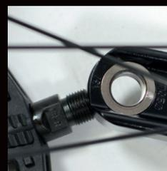
22) Die rechten Pedale haben ein „R“ auf der Achse, ebenso die Kurbeln innen. (Bild oben). Die linken Pedale und Kurbeln entsprechend ein „L“
