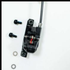
17) Den Adapter mit den kleinen Schrauben am Rahmen montieren. Die dünnen Scheiben sind zur seitlichen Verschiebung falls das Spiel im Adapter nicht reicht.
