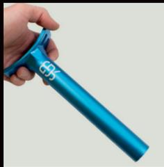
12) Prüfe die Sattelstützenlänge und kürze diese mit einem Rohrschneider falls nötig (entgraten nicht vergessen). Beachte die Mindesteinstecktiefe auf der Gabel!
