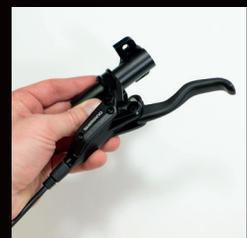
10) Den Bremshebel wie auf dem Bild einfädeln und die Schraube so festziehen, dass der Hebel fest genug sitzt so dass er sich im Falle eines Sturzes aber noch verdrehen kann (und so nicht bricht)
