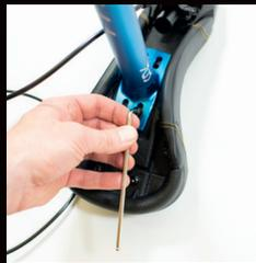
13) Die Schrauben+Unterlegscheiben auf der Unterseite des Sattels entfernen und die Stütze mit der Skala nach hinten auf die Unterseite des Sattels montieren.
