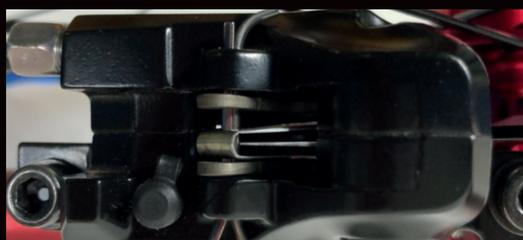
21) Jetzt den Bremssattel einstellen - am Besten geht das auf einem hellen Untergrund, da man dann, wie hier auf dem Bild links und rechts der Scheibe den Freiraum zu den Belägen gut sehen kann. Das sollte am Ende ähnlich wie hier auf dem Bild oben aussehen und dann auch nicht schleifen. Sollte das seitliche Spiel nicht reichen, die dünnen Scheiben zwischen Bremsadapter und Gabel anbringen.
