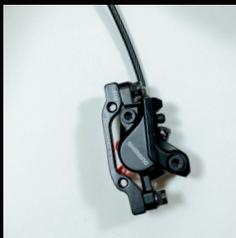
16) Die Schrauben lose anziehen, hier wird nachher noch der Sattel seitlich eingestellt bevor diese fest angezogen werden.
