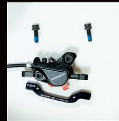
15) Jetzt den Bremsattel auf den Adapter montieren. Das A2Z-Logo muss nach oben zeigen, hierfür die längeren Stahlschrauben mit dem blauen Nylok verwenden.
