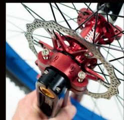
5) Lagerschalen mit der abgeschrägten Seite nach innen montieren, die M6x25 Schrauben einsetzen.
