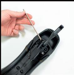
11) Jetzt den Bremshebelhalter mit der runden Seite nach vorn zeigend wieder montieren und mit den 4 mm Innensechskantschrauben fixieren.
