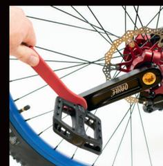
23) Die rechte Pedale im Uhrzeigersinn fest ziehen, die linke gegen den Uhrzeigersinn. Nach den ersten Fahrten unbedingt kontrollieren und nachziehen.
