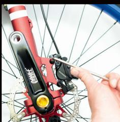
20) Den Bremssattel auf die Scheibe fädeln und gut am Bremssockel der Gabel fest schrauben.
