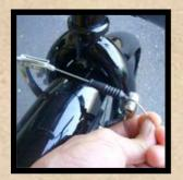
REPEAT OPERATION FOR OTHER BRAKE-LEVER. THEN FIX THE CABLE IN THE BRAKE LIKE ON THE PICTURE ON THE LEFT. IF YOU HAVE NO EXPERIENCE IN BIKE-ASSEMBLY, GO TO A BIKE SHOP AND ASK AN EXPERT, IT'S FOR YOUR OWN SAFETY!
